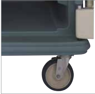
Las ruedas están compensadas para facilitar el movimiento por superficies con desnivel. Esta es una característica estándar en los modelos MDC1520S10, MDC1520S10D, MDC1520S20, MDC1418S20, MDC1520T20, MDC1520T30, MDC1418T30 y MDC1411T60.
